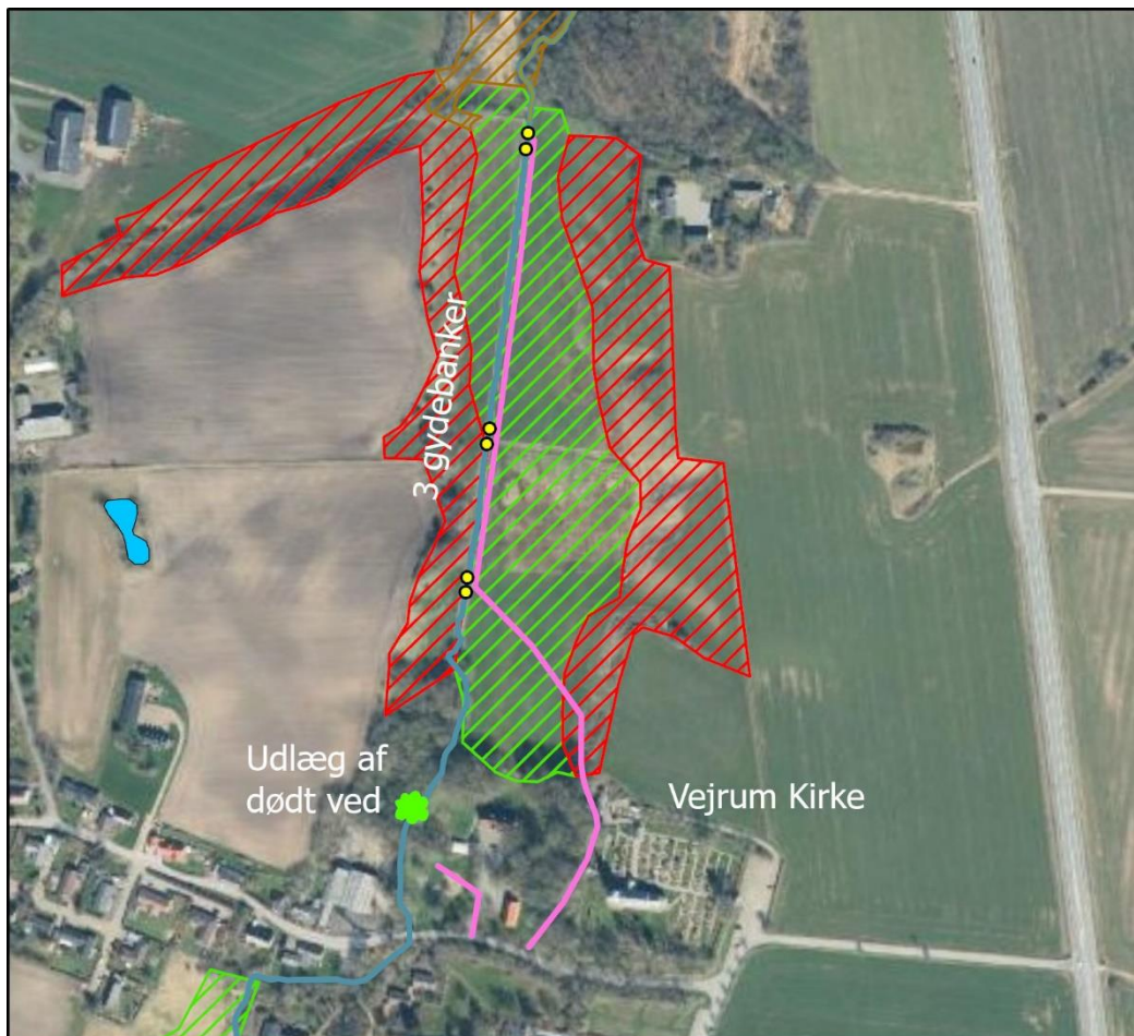
Figur 7: Projekterede indsatser omkring område 4. Adgangsveje er vist med pink. Udlægning af dødt ved er vist med en grøn trækrone.
